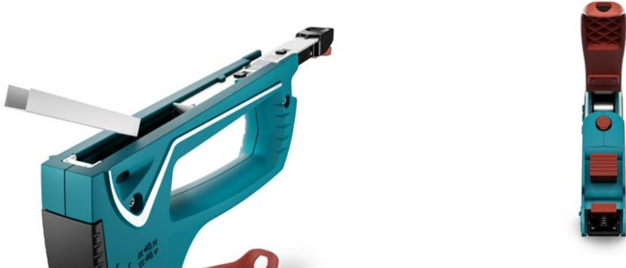
Die Ladekapazität dieses Tackers beträgt 150 Stück Feindrahtklammern A Typ 53 bzw. H Typ 37 oder 85 Stück Flachdrahtklammern D Typ 53 F bzw. G Typ 11.
