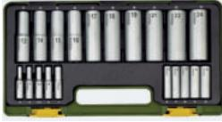
20-teilig. Mit 1/4"-Vierkantantrieb 6,3 mm. Für Anzugsdrehmomente unter 25 Nm. Sechskanteinsätze für SW 4 - 5 - 5,5 - 6 - 7 - 8 - 9 - 10 - 11 und 12 mm. Mit 1/2""-Vierkantantrieb 12,5 mm, für Anzugsdrehmomente über 25 Nm. 13 - 14 - 15 - 16 - 17 - 18 - 19 - 21 - 22 und 24 mm.
