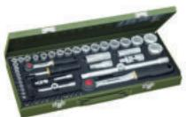
56-teilig. Steckschlüsseleinsätze von 4 - 32 mm. Zündkerzenspezialeinsätze 16 und 21 mm. Schraubereinsätze mit Vierkantantrieb für Schlitzschrauben, Kreuzschlitzschrauben, TX-Schrauben (mit stirnseitiger Bohrung) und Innensechskantschrauben. Innen-sechskantschlüssel (abgewinkelt) Gr. 1,25 - 1,5 - 2,0 - 2,5 und 3,0 mm.
