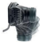
1 CREE Power Chip. Schiebe-Hyperfokus. Spritzwasserdicht IPx4. Stromquelle sind 3 AAA Batterien. 3-stufige Steuerung durch Tasten. Leistungsstufen: Max 340 lm / Standard 110 lm / Dimmung 6 - 160 lm. Leuchtwelte: Max 3 h 30 min / Standard 10 h / Dimmung 80 h.
