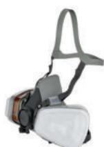
2 Stk. pro Packung. Filter ist wechselbar. Wiederverwendbare Maske, A2-Schutz vor organischen Gasen und Dämpfen und P2-Schutz vor mittleren Belastungen durch Feinstaub sowie vor Öl- oder Wasserdämpfen. Geringerer Atemwiderstand durch Doppel-Einatemventil und grosse Filter. Nicht für isocyanathaltige Farben verwenden.
