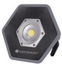
COB LED, 6500K, Aluminium und 2K-Kunststoff. IP65 / IK07. Integrierter Li-ion Akku 11.1 V, 5200 mAh, 57.72 Wh. Leuchtweite bis zu 80 m. Leistungsstufen: Hoch: 4400 lm, Mittel: 2200 lm, Niedrig: 1100 lm. Brenndauer: Hoch: 1 h 30 min, Mittel: 3 h 15 min, Niedrig: 6 h 30 min.
