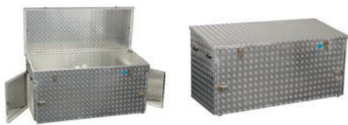
Riffelblechbox R 883 aus legiertem Alu-Riffelblech 3 mm. Ca. 883 l Volumen. Je einer Seitentüre links und rechts, 4 Verschlüsse. Vorrichtung für eine Werkzeugablage. Ösen Durchmesser Verschlüsse 10 mm. Schiefer Deckel, von hinten nach vorne abfallend. Max. Tragkraft stehend: 300 kg / mit Griffen: 120 kg.
