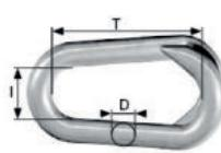
Notglied zum Verbinden von Kunststoffketten. Kann per Hand verpresst werden. Darf nicht als Anschlagmittel zum Heben von Lasten im Sinne der Maschinenrichtlinie 2006/42/EG benutzt werden. Nicht geeignet für Personensicherung.
