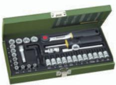
36-teilig. Steckschlüsseleinsätze von 4 - 13 mm. Schraubereinsätze mit Vierkantantrieb für Schlitzschrauben, Kreuzschlitzschrauben, TX-Schrauben (mit stirnseitiger Bohrung) und Innensechskantschrauben. Dazu 5 abgewinkelte Innensechskantschlüssel Gr. 1,25 - 1,5 - 2,0 - 2,5 und 3,0 mm.
