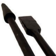
Mit Spitze Durchmesser 60 mm und Breite Schneide ca. 60 mm.
