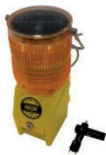
Körper aus Polyethylen, Linse aus Polycarbonate, Stoss- und Bruchsicher, kombinierter Betrieb Solar und Batterie, automatische Umschaltung von Solar auf Batterie, Garantiertes Dauerlicht, Wasserdicht IP 65, inkl. Schlüssel, ohne Batterie und Pfostenhalterung.
