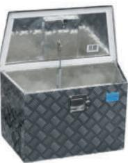
Deichselbox für Autoanhänger, Wohnwagen und LKWs aus Aluminium-Riffelblech ist geeignet, um Werkzeuge, Spanngurten und vieles mehr zu verstauen und sicher zu transportieren. Sie sind als Anfahr bzw. Unterfahrschutz zu nutzen. Alu Riffelblech 1.6 mm. Rundum geschweißte Nähte. Ohne Griffen. Mit Verschluss und 2 Schlüsseln. Staub- und spritzwassergeschützt durch umlaufende Gummidichtung.
