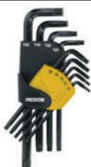
9-teilig. Winkelschlüsselsatz für TX-Schrauben. Je ein Stück TX 8 - 10 - 15 - 20 - 25 - 27 - 30 - 40 und 50. Aus Nickel-Chrom-Molybdän legiertem Spezialstahl. In praktischem Klapphalter.
