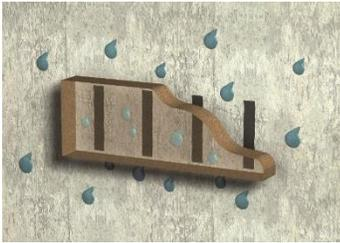
Le passage de l'air doit être assuré par un espace de 3 mm au moins (tout particulièrement en présence de deux supports non absorbants). L'épaisseur minimale du cordon de colle doit - tout particu-
